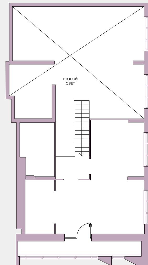
Вдохновляющая ухня-гостиная со «вторым светом», где высота потолков составляет 5,72 м. Высота потолков 1 и 2 уровня - по 2,72 м.
